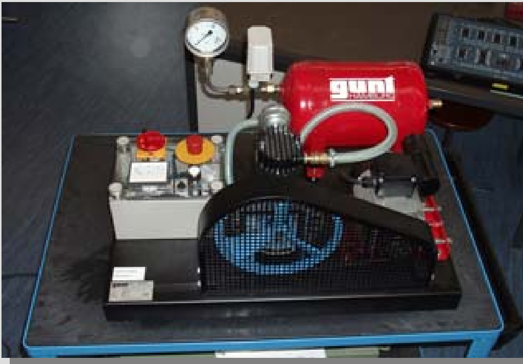
Druckluftherzeugungsanlage Fa. G.U.N.T. Gerätebau GmbH, Hamburg Leistungsaufnahme 0,7 KW, 10 bar
