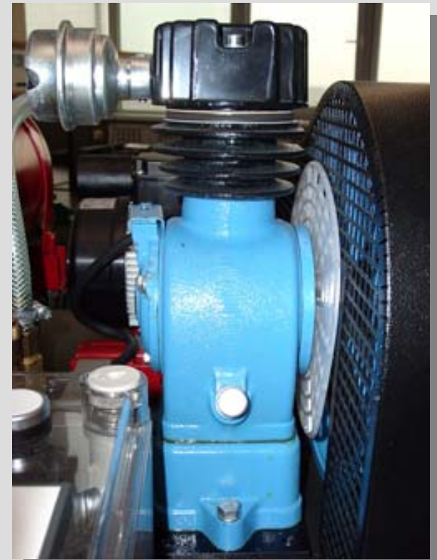
Luftgekühlter, einzylindriger Kolbenkompressor
